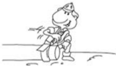
4. Medir la campana, se marca una medida en el extremo del tubo con el fin de verificar la profundidad de inserción.
