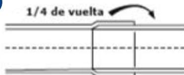
6. Insertar la espiga en la campana con un movimiento firme y parejo, la marca sobre la espiga indica la distancia a ser introducida, luego se procede a girarlo un cuarto de vuelta para distribuir mejor del pegamento.
