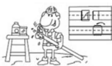
5. Aplicar el pegamento: se aplica con una brocha primero en la campana y solamente a un tercio de su longitud, después al extremo biselado del otro tubo en una longitud equivalente al de la campana.
