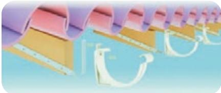
**Paso 2:** Para encajar las canaletas coloque en primer lugar la parte trasera de los soportes y gire la canaleta para abajo.
