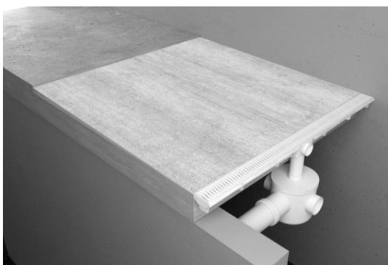
3B - Con la caja sifonada (pileta) incorporada en la losa.
