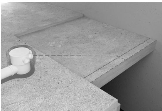
**Paso 4:** instale el perfil utilizando las conexiones apropiadas de acuerdo a lo indicado en el proyecto, uniéndolas con adhesivo plástico para PVC.
