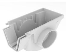
Pieza utilizada para realizar el cierre en un extremo de los perfiles y permitir la conexión con la red recolectora a través de un tubo de desagüe DN 40mm.
