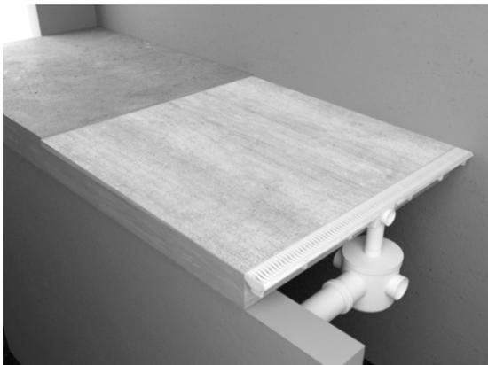
2B - Con la caja sifonada (pileta) incorporada en la losa.
