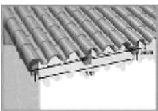
**En alero sin borde:** defina el sentido de las inclinaciones de acuerdo con la posición de los embudos. En este caso, el alineamiento de los puntos de fijación ya está predefinido por la posición de las vigas de madera. Sin embargo, es necesario marcar los desniveles entre los puntos, para respetar la inclinación de 0,5% hacia la canaleta. Fije el primero y el último tornillo. Estire una cuerda entre los tornillos y marque los puntos intermedios, en el centro de las vigas.
