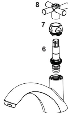
Monte el nuevo repuesto (6) enroscando el mismo al cuerpo del grifo, después de montar la tuerca de repuesto (7) apretando el mismo con las manos, luego instale el volante (8) colocándolo correctamente en la reparación y presionando para la fijación.
