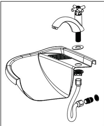
1) Antes de instalar el grifo, deje correr el agua para quitar la suciedad de la tubería.
