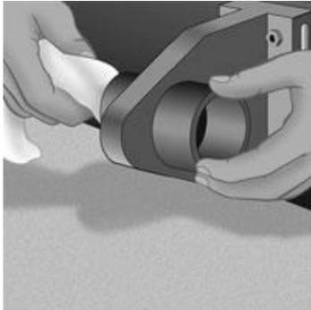
1. Antes de iniciar el proceso de termofusión es fundamental realizar la limpieza de las boquillas de la termofusora con un paño embebido en alcohol y verificar su correcto ajuste sobre la plancha del equipo.
