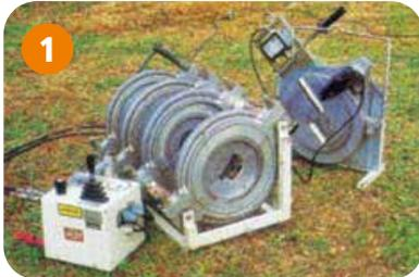
**Paso 1:** Los equipos comúnmente utilizados en las soldaduras a tope o termofusión, están constituidos por 3 elementos: unidad de fuerza (compuesta de una unidad hidráulica y un alineador), cuchilla de corte y placa calentadora.
