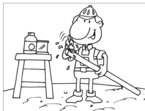
6. Insertar la espiga en la campana con un movimiento firme y parejo, la marca sobre la espiga indica la distancia a ser introducida, luego se procede a girarlo un cuarto de vuelta para distribuir mejor el pegamento.
