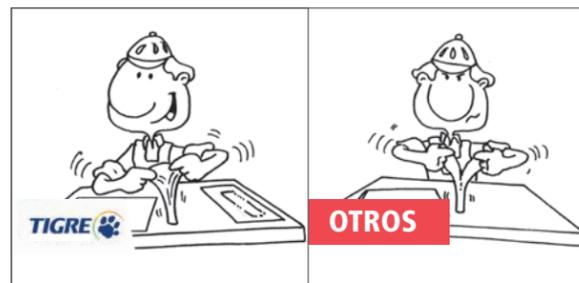
**Recomendación:** Para el sellado de la rosca, no utilizar materiales como hilos o fibra de cáñamo con pintura ya que pueden causar exceso de espesor y tensiones adicionales en los accesorios, aumentando el riesgo de rotura en los mismos.
