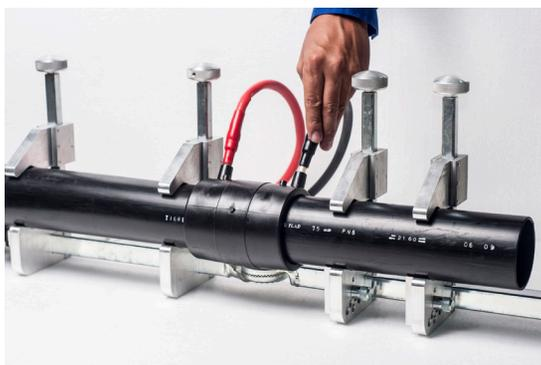
**Paso 5.** Conecte los electrodos de la electrofundidora al accesorio verificando los colores de los terminales, realice la soldadura activando la soldadora. Deje enfriar el tiempo indicado en la etiqueta antes de quitar el alineador.
