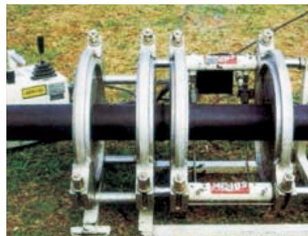
**Paso 7.** Solamente después de logrado el enfriamiento requerido, puede mover el equipo para una próxima soldadura.
