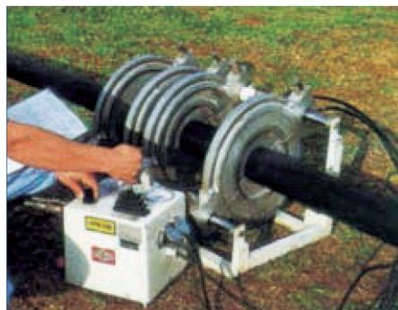
Los equipos comunmente utilizados por termofusión están constituidos por tres elementos: unidad de fuerza (compuesta de una unidad hidráulica y un alineador), refrentador y placa calentadora.
