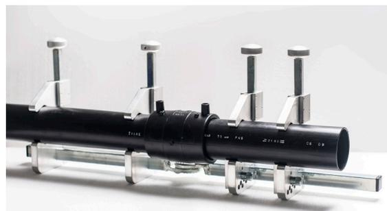
**Paso 4.** Realice los pasos anteriores para el tubo opuesto, retire el accesorio del embalaje e introduzca el tubo hasta las marcas realizadas. La zona que se va a soldar debe permanecer estable e inmóvil, para esto es posible utilizar el alineador.
