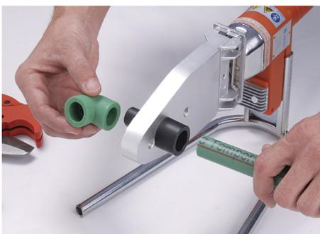
5. Verificar la temperatura de régimen a través del testigo de la termofusora. Al mismo tiempo que se introduce el tubo en la boquilla se deberá introducir también el accesorio, completamente perpendicular a la plancha de la fusora.
