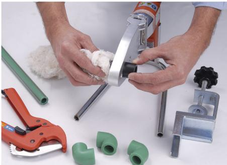
1. Es fundamental antes de comenzar cada fusión verificar la limpieza de las boquillas del termofusor y su correcto ajuste sobre la plancha.
