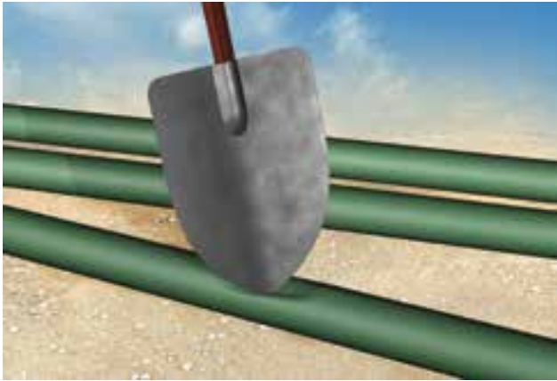
Proteger los tubos de los impactos en la obra.
