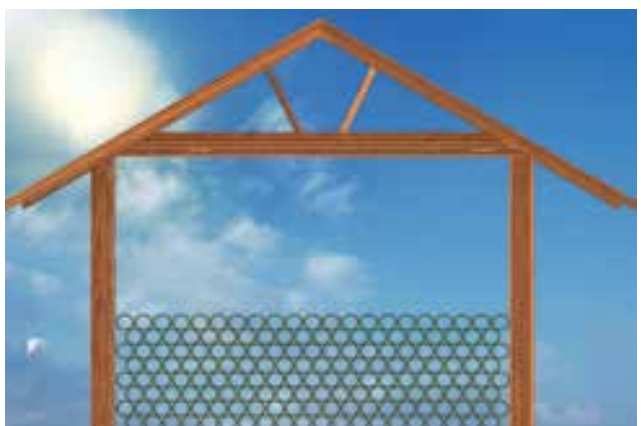
Almacenar y transportar los tubos y accesorios protegiéndolos de la luz solar y de la lluvia.
