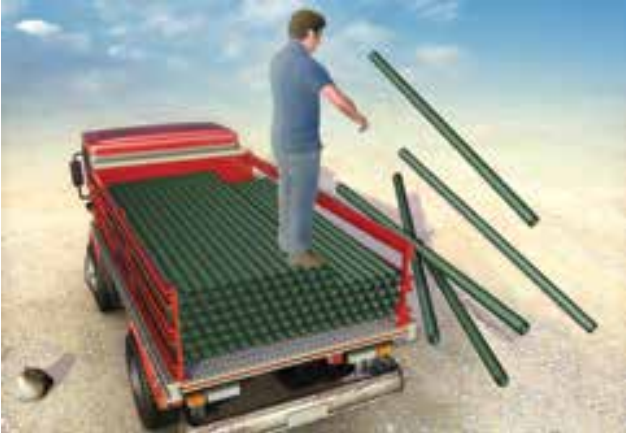
Evitar los impactos y golpes especialmente en los extremos de los tubos.
