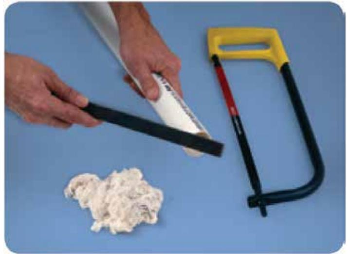
2. Desbarbar los cantos de corte. Biselar los extremos del tubo con un ángulo de aprox. 15°, utilizando una herramienta de biselar o una lima.
