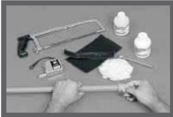
**Paso 1:** Lije las superficies que se soldarán utilizando lija 100. Pruebe el encaje entre las piezas, este debe ser bastante justo, casi imposible sin el adhesivo, pues sin presión no se establece la soldadura.
