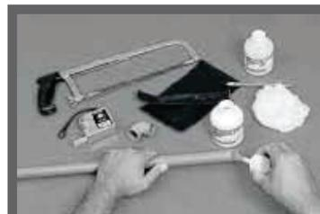
**Paso 4:** Encaje de una sola vez las extremidades que se van a soldar promoviendo un leve movimiento de rotación entre las piezas (1/4 de vuelta) hasta que alcancen la posición definitiva.
