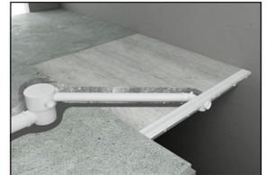
**Paso 4:** Instale el producto conforme especificado en su proyecto recordando que en el momento del hormigonado, el perfil debe estar con la rejilla colocada.
