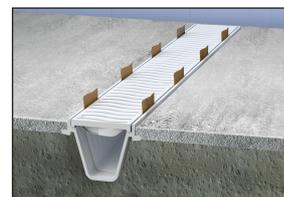
**Paso 5:** Realice el acabado con el piso deseado respetando la altura máxima del perfil.
