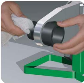
**Paso 1:** Antes de iniciar el proceso de termofusión es fundamental realizar la limpieza de las boquillas de la termofusora con un paño embebido en alcohol isopropílico y verificar su correcto ajuste sobre la plancha del equipo. Es importante que las boquillas se encuentren en buen estado, libre rugosidades.
