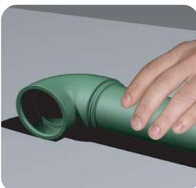
**Paso 8:** Después de culminado el tiempo de fusión, se recomienda dejar reposando la unión libre de esfuerzos durante el **tiempo de enfriamiento**, según lo especificado en la **Tabla N°01**. Pasado el tiempo de enfriamiento, ya podemos poner en funcionamiento la instalación o realizar pruebas hidráulicas.
