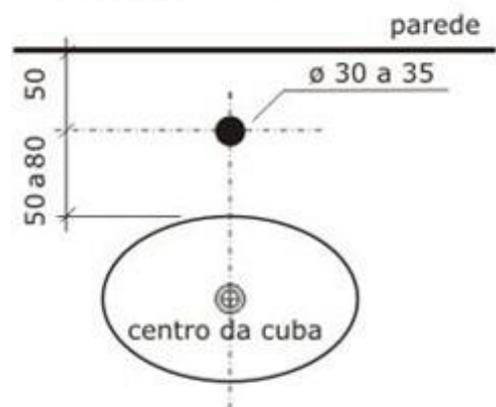
Espessura máxima da bancada = 35 mm
