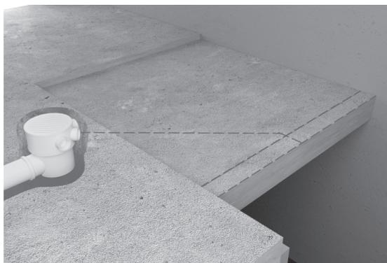
**Passo 5:** instale o perfil utilizando as conexões adequadas para o seu projeto unindo-as com adesivo plástico.
