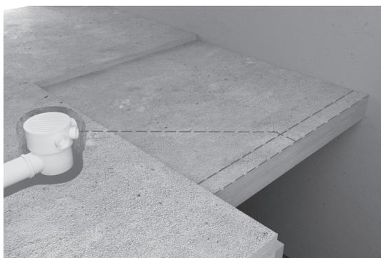
**Passo 4:** instale o perfil utilizando as conexões adequadas de acordo com o seu projeto unindo-as com adesivo plástico para PVC.
