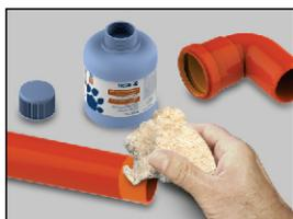
**Passo 5:** Aplicar a pasta lubrificante TIGRE no anel e na ponta do tubo. Não usar óleo ou graxa, que poderá danificar o anel de borracha;
