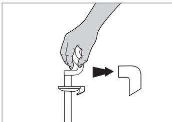
Passe fita veda rosca na haste (3 a 4 voltas são suficientes). Rosqueie lentamente a parede;
