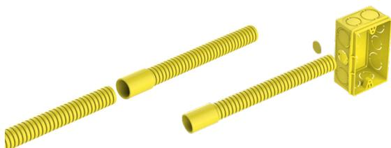
Os eletrodutos Tigreflex são conectadas às caixas de luz (ou caixas de derivação) e quadros de distribuição por simples encaixe, bastando para isto que se retirem da caixa as zonas circulares enfraquecidas (medalhas), nos pontos desejados.
