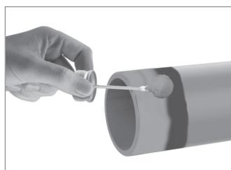
**Passo 9:** Aplique o adesivo para CPVC Sch.80 Tigre na área externa do tubo e na bolsa da conexão, enquanto as superfícies ainda estiverem úmidas. Evite o uso excessivo para que o adesivo não escorra no produto;
