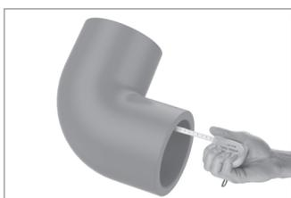
**Passo 4:** Com o uso de uma trena, faça a medição do comprimento total da bolsa da conexão. Em seguida, marque essa mesma medida na ponta do tubo;
