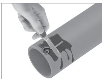
**Passo 5:** Antes de iniciar o processo de soldagem, faça um teste para verificar se há a reação entre o Primer e o material plástico. Para isso aplique o Primer em um pequeno pedaço de tubo que não será utilizado e raspe a superfície ainda úmida com uma faca. A penetração do Primer no tubo ocorre quando ao raspar o tubo você verifica a presença do Primer mesmo com a remoção de uma camada superficial de plástico;
