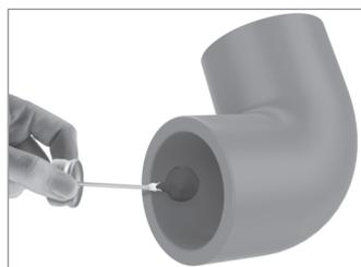
**Passo 8:** Aplique uma segunda camada do Primer para CPVC Sch.80 Tigre internamente na bolsa da conexão. Evite o uso excessivo para que o Primer não escorra internamente na conexão e no tubo.
