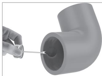
**Passo 6:** Com o uso de um aplicador apropriado, que corresponda à metade do diâmetro do tubo, aplique o Primer para CPVC Sch.80 Tigre internamente na bolsa da conexão até a superfície ficar maleável.
