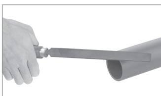
**Passo 2:** Com o uso de uma lima, chanfre a ponta do tubo entre 10-15° e remova as rebarbas e sujeiras do corte;
