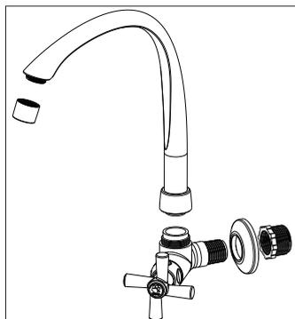
1) Antes de instalar a torneira, deixe correr a água para remover a sujeira da tubulação;
