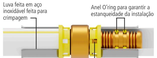
Janela de inspeção (espião) para controle visual da inserção do tubo na conexão
