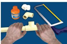
b) Encaixe de uma vez as extremidades a serem soldadas, dê 1/4 de volta e mantenha a junta sobre pressão manual por aproximadamente 30 segundos, até que o adesivo adquira resistência;
