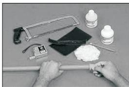
**Passo 4:** Encaixe de uma vez as extremidades a serem soldadas, promovendo um leve movimento de rotação entre as peças (¼ de volta) até que atinjam a posição definitiva. Remova excesso
