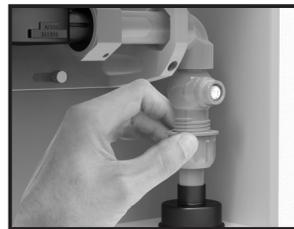
10. Conectar o tubo de PEAD Ø 20 mm no conjunto, desrosqueando a porca da conexão de entrada (peça A), e inserir o tubo PEAD no seu interior, rosqueando novamente a porca manualmente.
