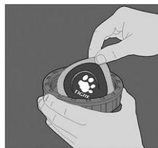
protetora somente 2 minutos após a soldagem. Esta película assegurará que não haverá escoamento de adesivo para o interior da válvula, o que poderia acarretar vazamentos.
