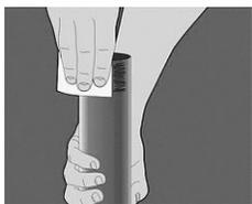
Passo 2: Lixe a superfície das tubulações e das bolsas da válvula apenas para retirar o brilho, utilize lixa Tigre nº 100. Em seguida limpe as superfícies utilizando a solução limpadora Tigre. Obs.: o procedimento padrão de soldagem pode ser utilizado (soltar a porca para efetuar a soldagem). Caso esta solda seja feita com o conjunto montado, a película não deverá ser removida até a finalização desta operação;
