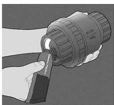
Passo 4: Faça o encaixe das partes e limpe o excesso de adesivo;
