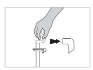
Passe fita veda rosca na haste (3 a 4 voltas são suficientes). Rosqueie lentamente a parede;
