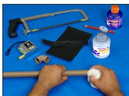
**Passo 3:** Distribua uniformemente o Adesivo Plástico para PVC TIGRE nas bolsas e nas pontas a serem soldadas (com pincel ou com o bico da própria bisnaga).
