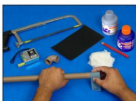
**Obs.:** Ao cortar o tubo, elimine as rebarbas e chanfre a ponta, para facilitar o encaixe nas conexões.
