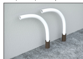
Tubos passando por uma laje
