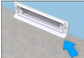
**Passo 13:** O piso na parede deve ser acomodado de forma que encoste conforme exemplo na figura indicada (cor cinza);
